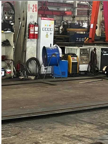
焊接烟尘移动式除尘器
